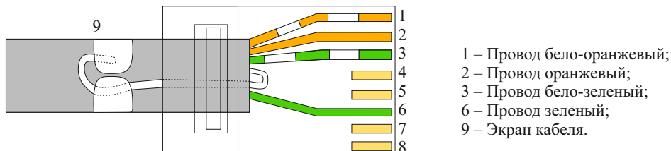
Рисунок 8 – Схема обжима при использовании 2-х парного кабеля по стандарту T-568B
